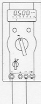
Sicherung ist in Ordnung: Intervallton und Anzeige ca. 0,5 V ~
